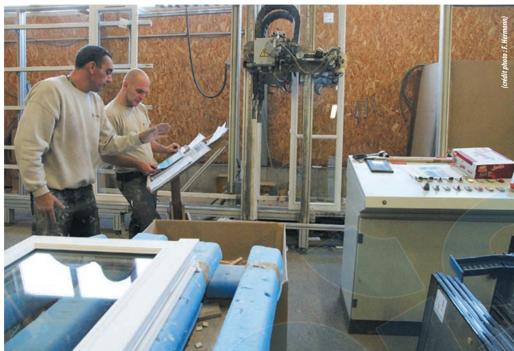
La siliconeuse double-tête Wintech dans l'atelier vitrage. LMA a mis en place une démarche qualité en parallèle de son adhésion en cours à Menuiserie 21.
